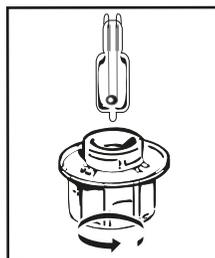
Puede cambiar la bombilla usted mismo cuando deje de funcionar. Desatornille el plafón y extraiga la bombilla (utilice un guante de goma que facilitará el desmontaje). Introduzca la nueva bombilla y vuelva a instalar el plafón.
